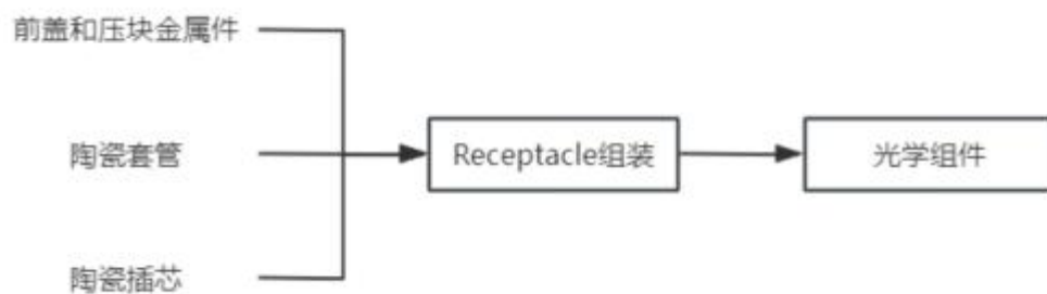
图 2.7-1 高速光模块配套无源器件总工艺流程图
